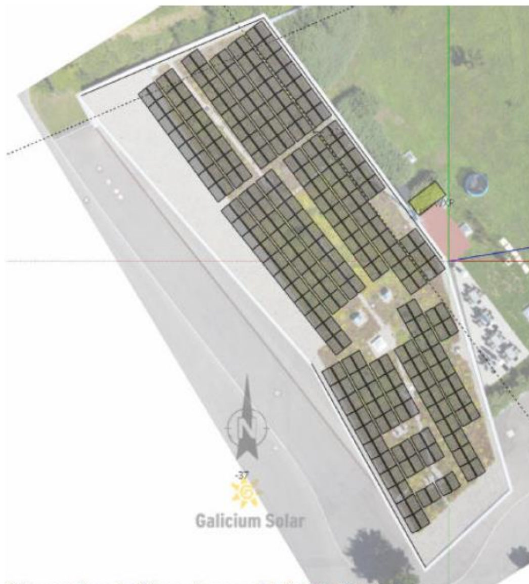
Belegungskizze: Ausführungsplanung nach Aufmaß der Dachhindernisse
